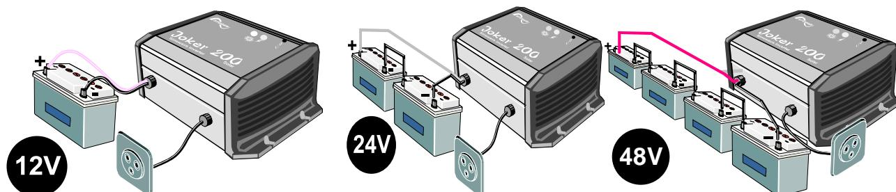
Conecte el ondulador a la batería. Cuando conecte la batería se producirá una chispa (**¡PELIGRO DE EXPLOSIÓN!**) a causa de la carga interna de los condensadores. ¡La batería tiene que estar protegida por un fusible en el borne!
