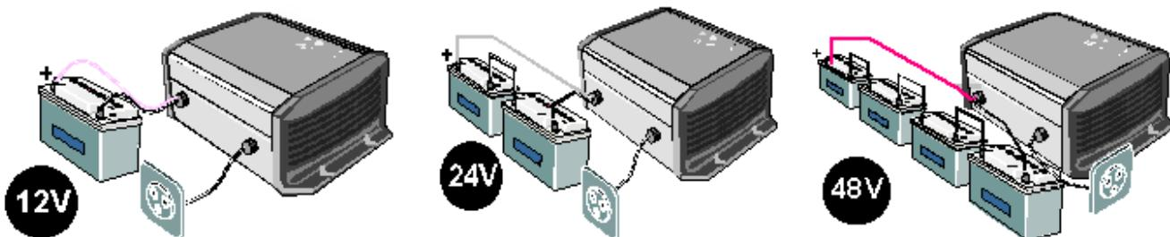
En branchant la batterie il y a une étincelle (**Danger d'explosion !**), en raison du chargement du condensateur interne. Un fusible de sécurité incendie doit être monté sur la batterie.
