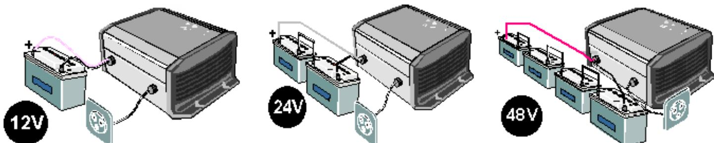
Den SOLO an die Batterie anschliessen. Beim Anschliessen der Batterie entsteht ein Funken (**EXPLOSIONSGEFAHR!**) wegen der Ladung der internen Kondensatoren. Die Batterie muss mit einer Sicherung auf der Batterieklemme versehen sein !
