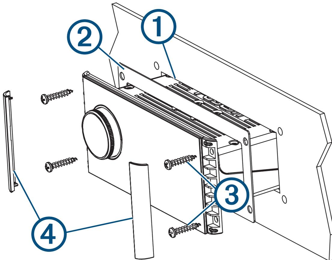
4 Assurez-vous que les trous de fixation de la chaîne stéréo sont alignés avec les trous d'implantation du modèle.
