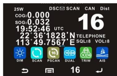
Quand un signal est détecté, alors le balayage se met en pause jusqu'à ce que le signal s'arrête. Si vous souhaitez arrêter le Scan alors appuyé de nouveau sur cette icône.
