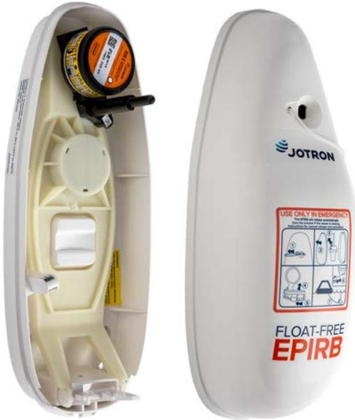
Le **FB-60** est un support fermé équipé d'une **unité de libération hydrostatique (HRU)**. Cette HRU libérera l'EPIRB si le support est submergé à une profondeur de 2 à 4 mètres ou plus. Lorsque le **Tron 60AIS** est monté dans le support **FB-60**, il fonctionne comme une unité flottante automatique.
