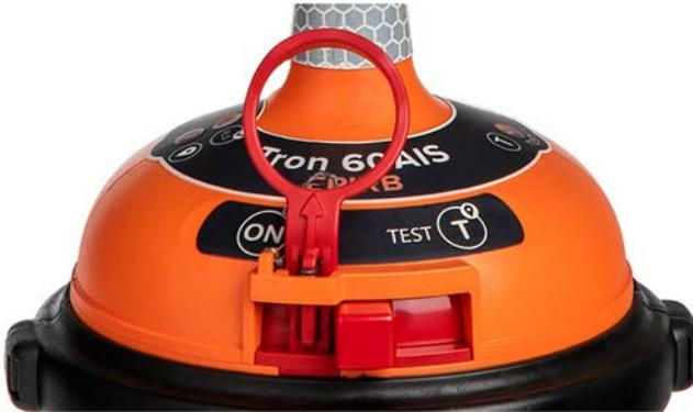
Une languette de retrait est située à côté de l'interrupteur et doit être enlevée pour déplacer l'interrupteur "ON". Cette languette ne bloque pas le déplacement de l'interrupteur en position "self-test" et ne doit pas être enlevée lors des tests normaux et des tests GNSS.
