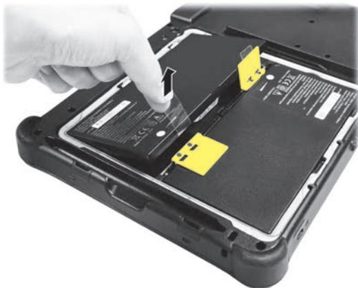
4. Mettez en place un autre bloc de batterie. Notez le sens de le bloc batterie. Maintenez le bloc batterie à un angle et insérez ses petites pattes dans les encoches correspondantes dans le compartiment de le bloc batterie. Puis, soulevez la feuille de protection jaune dans le compartiment de le bloc batterie et branchez le connecteur de le bloc batterie.
