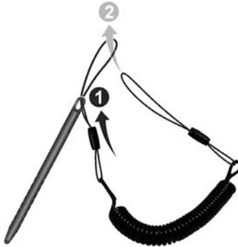
2. Insérez l'autre extrémité de la boucle dans le crochet sur l'ordinateur (comme indiqué par **1** ci-dessous). Puis, insérez l'extrémité du stylet à travers la boucle (comme indiqué par **2** ci-dessous) et serrez fermement.
