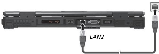
**REMARQUE :** Le module LAN2 intègre DSM (Deep Slumber Mode – Mode Hibernation Profonde) pour économiser la batterie. Le courant est fourni aux modules LAN seulement quand un câble réseau est connecté. Cela veut dire que le module LAN n'apparaîtra pas dans le **gestionnaire de périphériques** Windows si le câble est déconnecté mais apparaîtra bien entendu dans le cas contraire.
