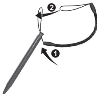
2. Insérez l'autre extrémité de la boucle dans le crochet sur l'ordinateur (comme indiqué par ❶ ci-dessous). Puis, insérez l'extrémité du stylet à travers la boucle (comme indiqué par ❷ ci-dessous) et serrez fermement.
