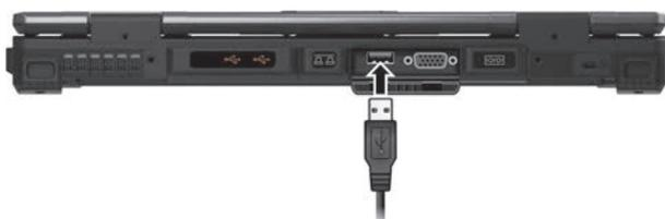
Un appareil connecté est rechargé par une alimentation externe (si l'adaptateur CA est branché) ou par la batterie de l'ordinateur (si l'adaptateur CA n'est pas branché). Dans le dernier cas, la recharge s'arrête lorsque le niveau de la batterie devient faible (20 % de capacité).
