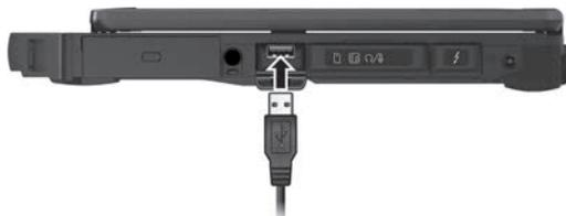
**REMARQUE :** Certains modèles disposent d'un port USB PowerShare. Si nécessaire, vous pouvez modifier les paramètres et utiliser ce port comme un port USB 3.2 Gen 1 standard. (Voir la section suivante « Raccordement d'un appareil pour la recharge USB (optionnel) » pour plus d'informations.)
