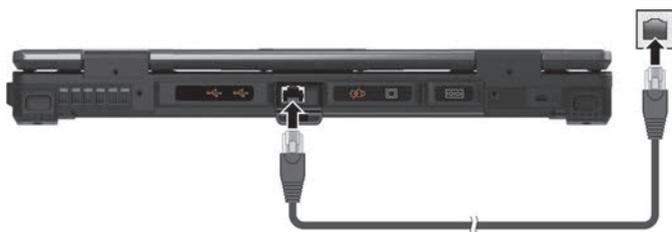
Certains modèles disposent d'un deuxième module LAN vous permettant ainsi de vous connecter à deux réseaux en même temps.
